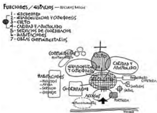
Ilustración 2. Función/ espacios, en la construcción del proyecto como resultado de la integración del Programa Arquitectónico. Fuente: (Pasarín, 2007).
