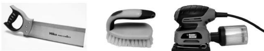
Figura 10. Ejemplos de aplicaciones mal logradas de productos con asas de “agarre cómodo” (de izquierda a derecha). En el primer ejemplo, el material elastomérico es apropiado al agarre, sin embargo es tan delgado que al momento del uso termina sintiéndose la rigidez del sustrato. En el segundo ejemplo, el material elastomérico es tan duro como el cuerpo del cepillo. En el tercer caso, el material elastomérico es apropiado al tacto, sin embargo al esfuerzo del corte se deforma, provocando una sensación de inestabilidad en la acción de corte Fuente: Catálogo en línea de Grainer
