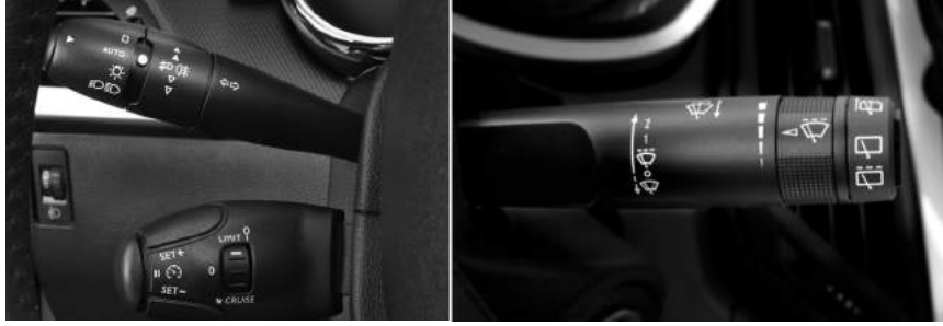
Figura 6. Ejemplos de desarrollo de interfaces hápticas en la industria automotriz. Izquierda: Palancas de encendido de luces/direccionales y control de velocidad de cruce (Peugeot 206), Derecha: Palanca de encendido de limpiabrisas delantero y trasero (Equinox, GM) Fuente: www.peugeot.fr / www.chevrolet.com/equinox
