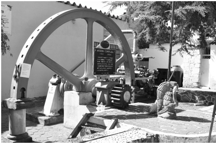
FIGURA 4. MOTOR A VAPOR COLLTD GLASGOW-1910 A LAS AFUERAS DEL INGENIO PEDERNALES. FUENTE: FOTOGRAFÍA DE L. ALFREDO AYALA ORTEGA, 2022.
