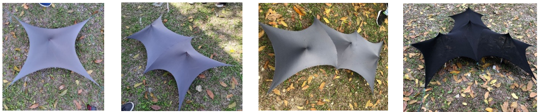
FIGURA 18-21. CONFIGURACIÓN DEL MÓDULO DE TENSEGRIDAD CON VARIAS ADAPTACIONES DE CUBIERTAS TENSADAS. FUENTE: MORALES, 2019A.
