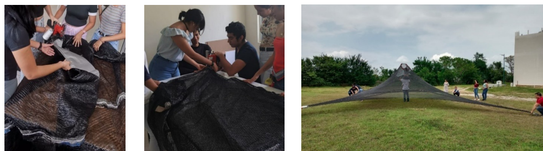
FIGURA 42-44. MANUFACTURA DEL PATRONAJE DE LA MALLA SOMBRA DE INVERNADERO.
