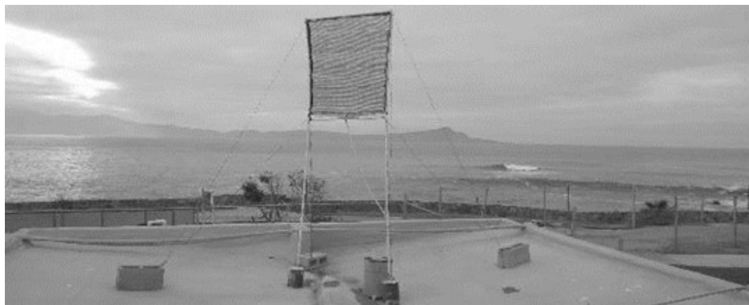
Figura 11 . Experimento ubicación 2 UABC, arriostramientos diagonales.
