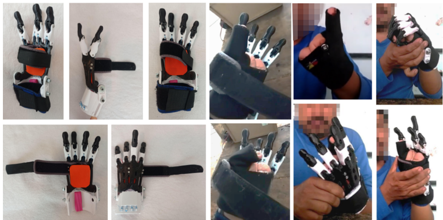
FIGURA 6. IZQUIERDA, PRÓTESIS EXPERIMENTAL ENSAMBLADA, DERECHA, USUARIO EN INTERACCIÓN CON LA PRÓTESIS EXPERIMENTAL. FUENTE: ELABORACIÓN PROPIA A PARTIR DEL PRODUCTO TERMINADO.
