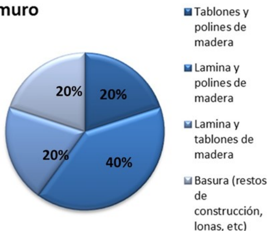
Figura 8. Materiales utilizados en vivienda informal, tipología: precaria. Fuente: Elaboración propia.
