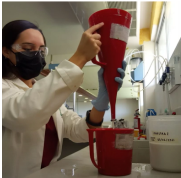
FIGURA 6. PROCEDIMIENTO DE LA PRUEBA DE VISCOSIDAD. FUENTE: FOTOGRAFÍA DE NATALIA FRANCO RUIZ, CIUDAD MADERO (2020).
