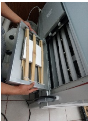
FIGURA 8. INTRODUCCIÓN DE LAS MUESTRAS A LA CÁMARA DE ENVEJECIMIENTO. FUENTE: FOTOGRAFÍA DE NATALIA FRANCO RUIZ, CIUDAD MADERO (2020).
