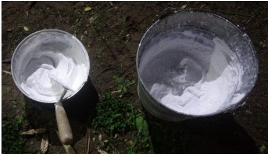
FIGURA 4. RESULTADO DEL PROCESO DE APAGADO DE LA CAL VIVA. FUENTE: FOTOGRAFÍA DE NATALIA FRANCO RUIZ, CIUDAD MADERO (2020).
