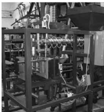
Imagen 1. Máquina de fabricación de tabique de plástico.
