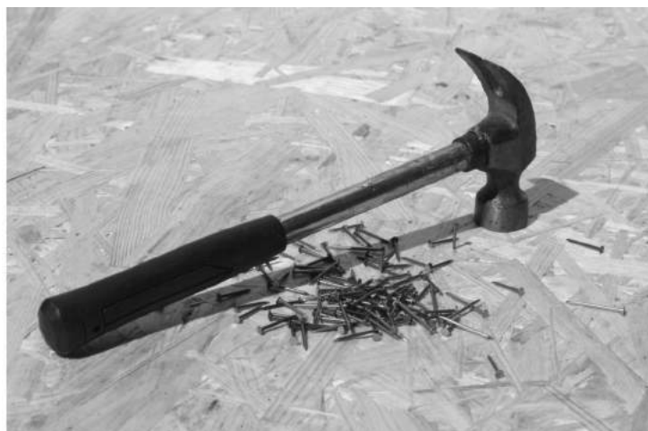
Figura 5. Ejemplo de herramienta al cual se le ha colocado un recubrimiento "suave" para mejorar el agarre; sin embargo, este mango tiende a moverse (con el movimiento de uso) por estar superpuesto Fuente: espanol.torange.biz
