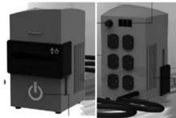
Figuras 5. Propuesta regulador interruptor frontal realizada por alumno del grupo 01 diseño de electrodomésticos, con 6 contactos posteriores.
