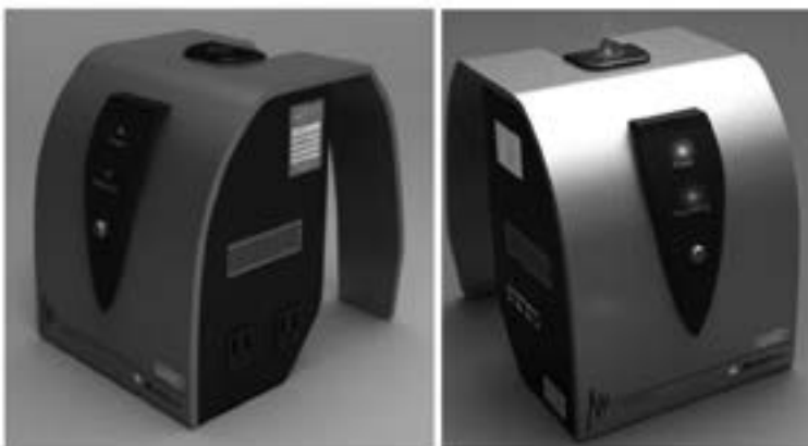
Figura 2. Propuesta regulador realizada por alumno del grupo 01 diseño de electrodomésticos, con 4 contactos posteriores y dos contactos laterales.
