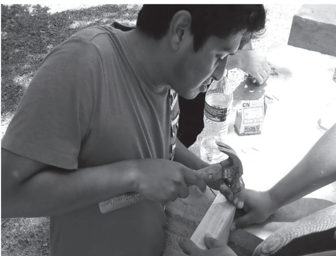
FIGURA 1 Y 2. ARMADO DE LOS MARCOS DE MADERA PARA RELLENARLOS CON LAS DIFERENTES MEZCLAS DE SUELO. FUENTE: FOTOGRAFÍAS DEL AUTOR.
