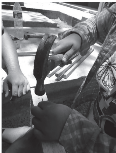
FIGURA 1 Y 2. ARMADO DE LOS MARCOS DE MADERA PARA RELLENARLOS CON LAS DIFERENTES MEZCLAS DE SUELO. FUENTE: FOTOGRAFÍAS DEL AUTOR.
